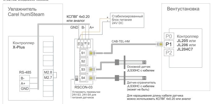
**Внимание!** Если к порту Р1 также подключено другое оборудование (например, модуль JL201DPR), то на этом оборудовании необходимо изменить параметры работы ModBus, а именно установить параметр **четность** «**Het**» (без контроля четности).
