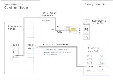
Подключение производится двумя кабелями:
