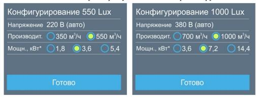
Напряжение питания калорифера (380B / 3 фазы или 220B / 1 фаза) выбирается автоматически в зависимости от типа электропитания вентустановки.
