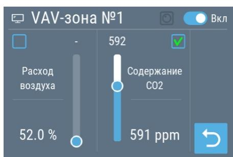
Левый ползунок позволяет задать расход воздуха, который будет автоматически поддерживаться. Расход воздуха задается в процентах, либо в м<sup>3</sup>/ч (задается при сервисной настройке VAV-системы). Правый ползунок позволяет задать желаемое значение параметра, который измеряет датчик, – это значение будет поддерживаться путем изменения расхода воздуха в зоне.
